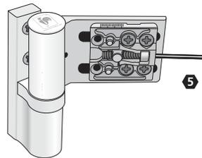
Horizontalverstellung stufenlos ± 5mm
